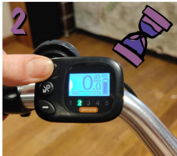
Pour allumer les phares, on appuie quelques secondes sur le bouton +
