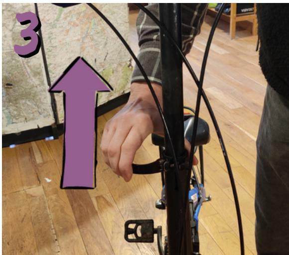
On ouvre le levier de réglage de la potence et on la monte au maximum
