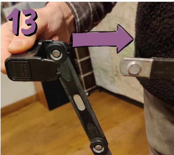
On tire sur la partie gauche de l'antivol afin de l'ouvrir. On attache ensuite toujours le vélo à un point fixe
